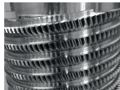
Werkstück mit verdrahter Spannutt
